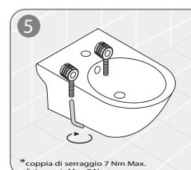
5 - Fissare il bidet mediante i perni di fissaggio. Si consiglia di avvitare alternativamente i dadi in modo da ottenere un fissaggio migliore del bidet alla parete.
